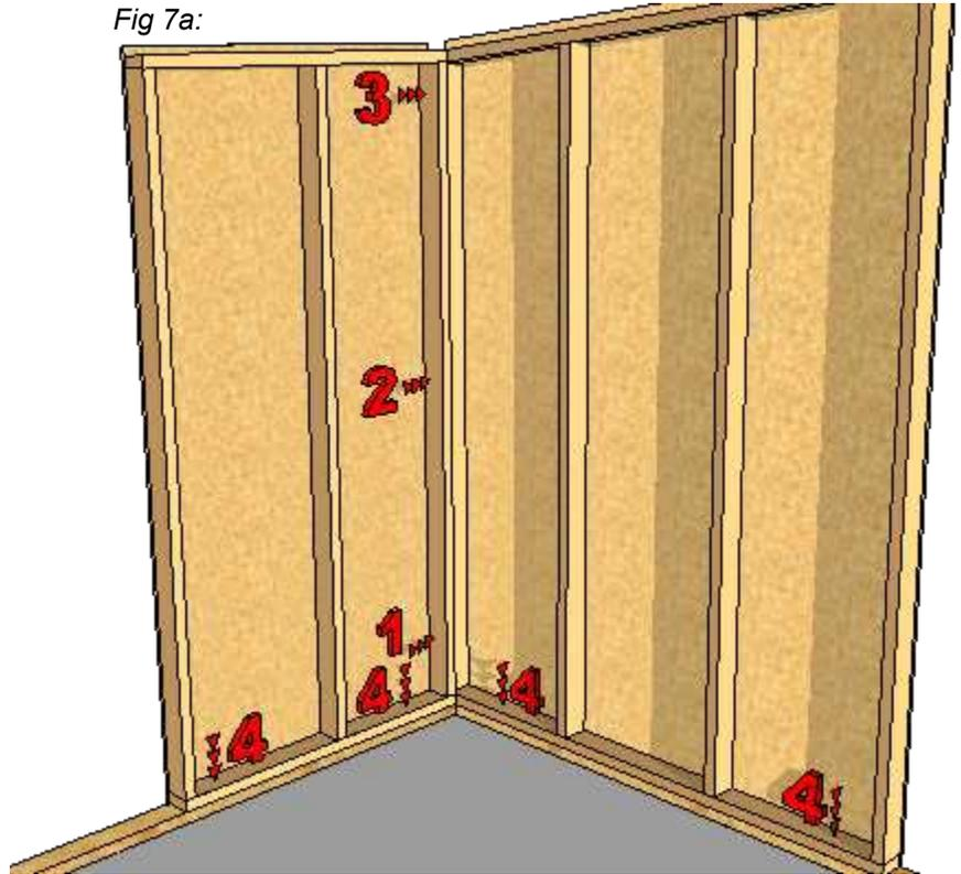
**STAND AND LOOSE FIT REMAINING BACK AND SIDEWALL PANELS:**
