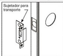
Retire el sujetador para transporte.
