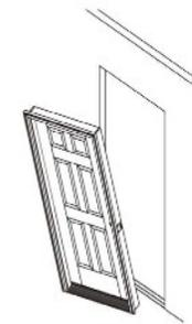
Levante la unidad. Con el borde superior inclinado, aléjelo de la abertura, centre la unidad y coloque el borde inferior de la puerta en la solera inferior o en los cordones de masilla de calafateo, luego inclínelo hacia la abertura.
